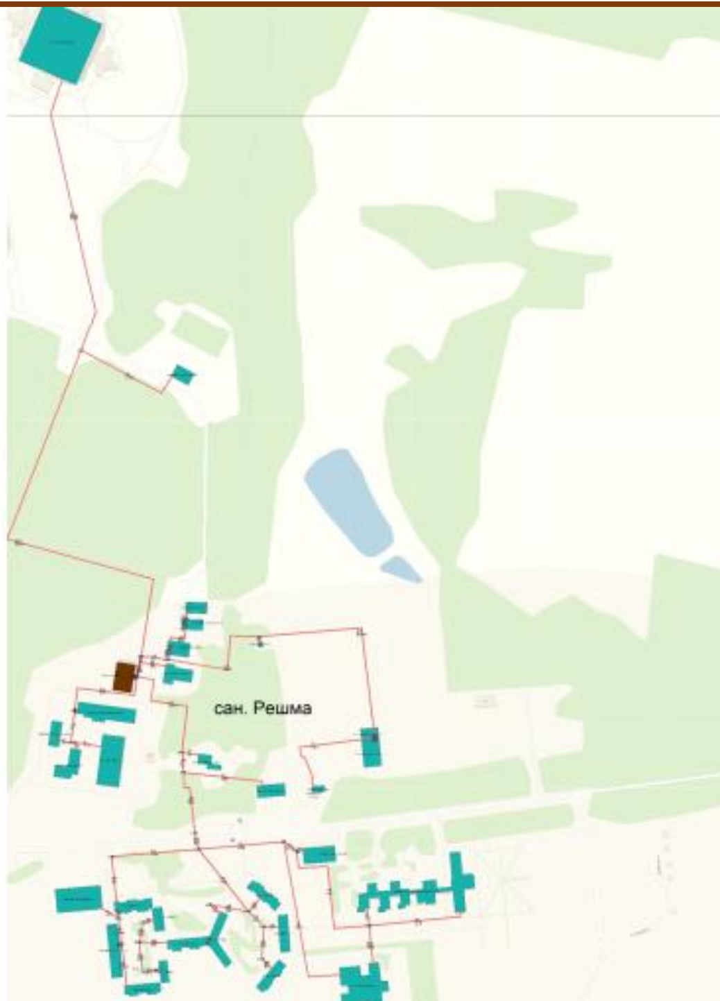
Схема сетей отопления от котельной санатория «Решма».
